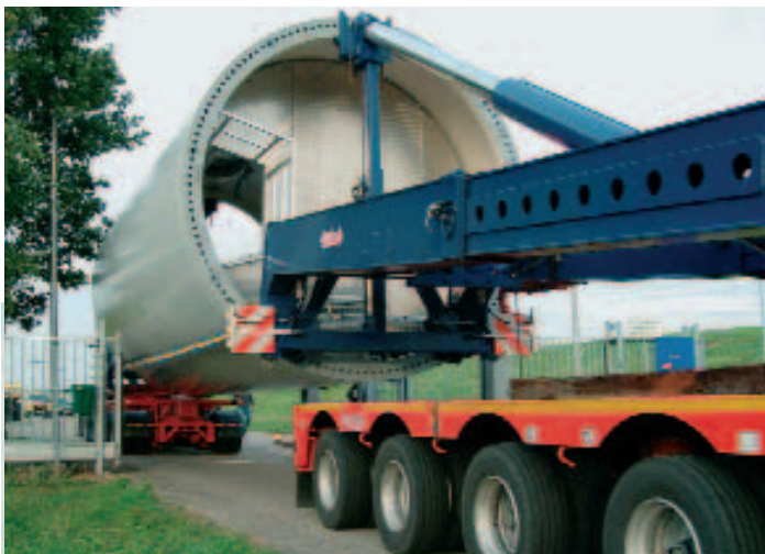
Der Nootboom MegaWindmill-Transporter besteht aus zwei hydraulisch ausfahrbaren Liftadaptern, die universell für unterschiedliche Fahrzeugtypen genutzt werden können. Im vorliegenden Fall ist ein solcher Liftadapter auf einem 6-achsigen hydraulisch gelenkten Semi-Tieflader und ein zweiter Liftadapter auf einem 7-achsigen hydraulisch gelenkten Nachlauf-Dolly montiert.
