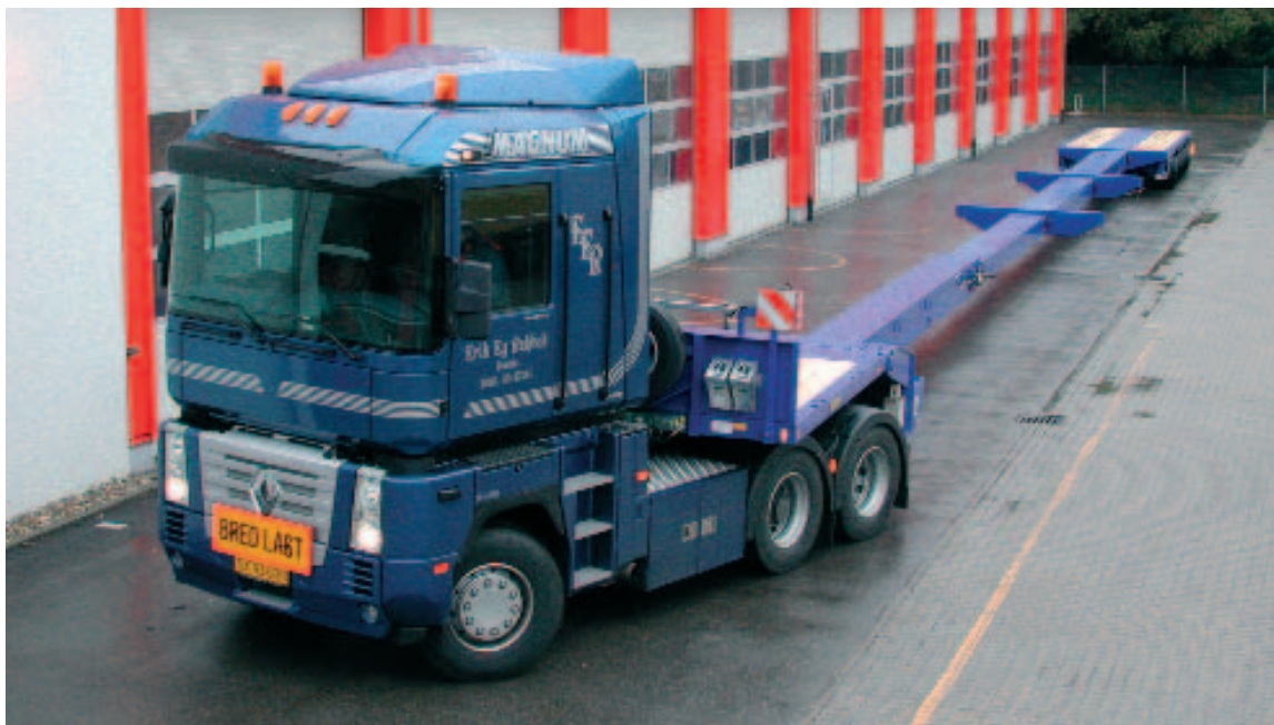
Der Doll Vario S4H-DSF: Mit eingehängter Röhre erhöht sich die Sattel-Gesamtlänge im teleskopierten Zustand von 33.360 mm auf 42.360 mm.
