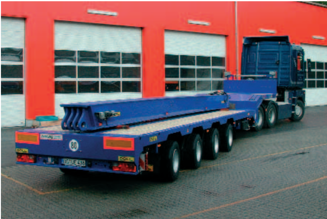
Nach dem Abbolzen findet die Röhre bequem auf der 9.600 mm langen Tiefladeplattform Platz.
