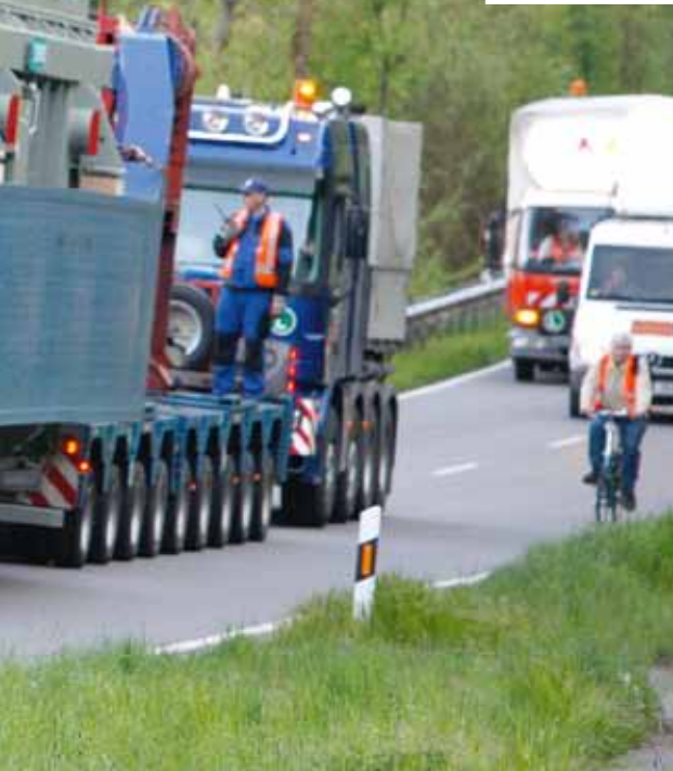
Während der Transformator sicher im Schnabelwagen ruht, sorgen zwei Zug- und eine Schubmaschine für die notwendige Antriebskraft.
