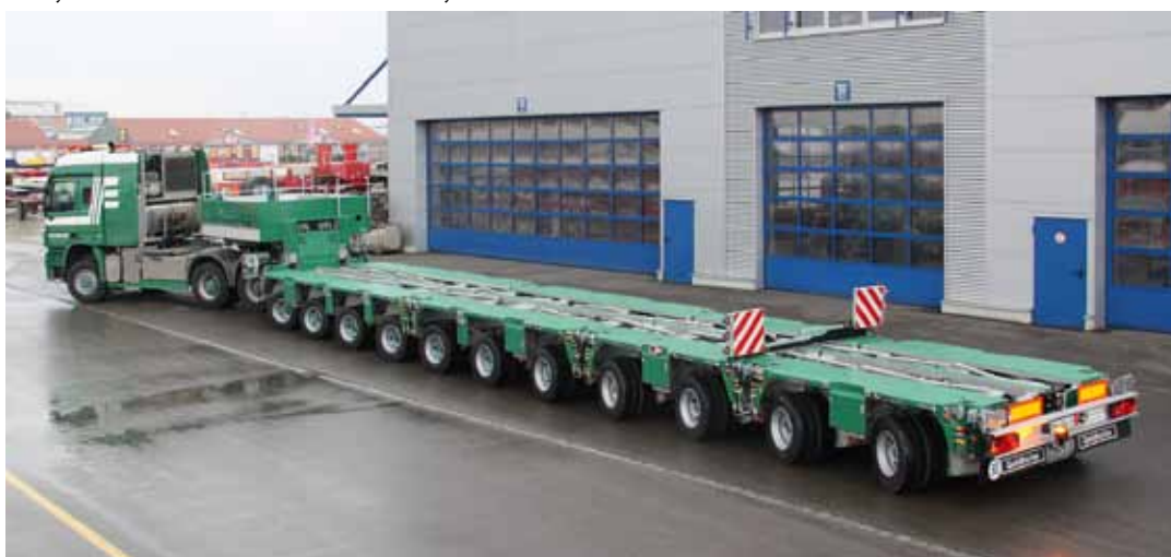
Die neue Goldhofer Schwerlastkombination STHP/UT 11, die an die Martin Brunner Transport AG geliefert wurde, lässt sich flexibel einsetzen. Maximal sind 122 t Nutzlast möglich.
