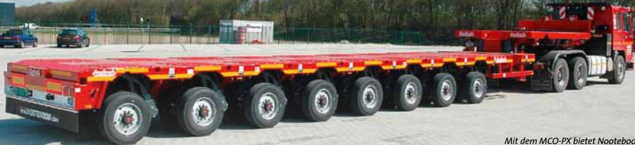
Mit dem MCO-PX bietet Nootboom jetzt einen Semi-Tieflader mit Pendelachsen.
