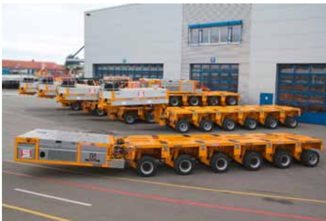
Superpesa aus Brasilien hat unter anderem in die neue modulare Schwerlastbaureihe THP/PST, die 45 t Achslast bietet, investiert.
