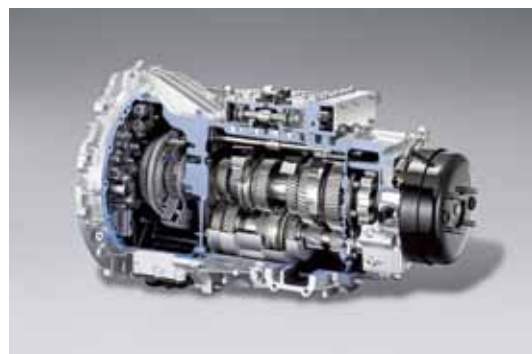
Das neue Doppelkupplungs-Getriebe von Fuso fährt sich wie ein automatisches Getriebe, soll jedoch im Gegensatz zu einem vollautomatischen Wandlergetriebe geringere Kraftstoffverbräuche und damit geringere Abgasemissionen erreichen.
