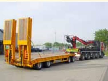
Doppelrampen, Luftfederung: der Broshuis-Anhänger kam bei den Besuchern gut an.
