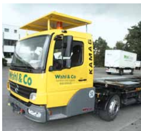
Die neueste „Wiesel“-Generation gibt es in Hannover zu sehen. Im Bild ein „Wiesel“ mit einem Schutzdach, das vor Eisplatten schützt. Sie stellen insbesondere beim Einsatz von Planenbrücken eine Gefahr dar.
