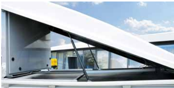
Integrale Bauweise: Das Öffnen und Schließen der Anlage wird bequem vom Fahrerhaus gesteuert.
