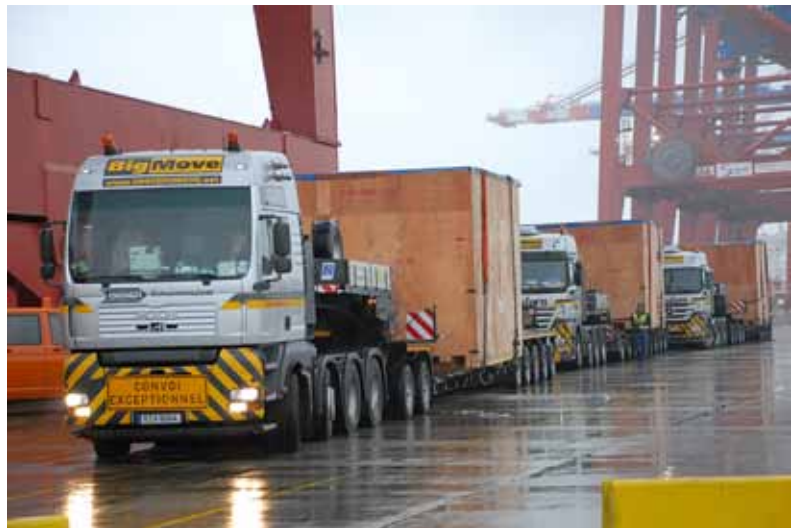
Hier werden Anlagen-Komponenten mit je 72 t Ladungsgewicht im Verbund vom Hafen Hamburg aus auf den Weg gebracht.
