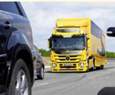
Der Active Brake Assist 2 basiert auf einem neuen scannenden Radarsystem. Es tastet einen Bereich von 1 bis 150 m in der Spur vor dem Lkw ab.
