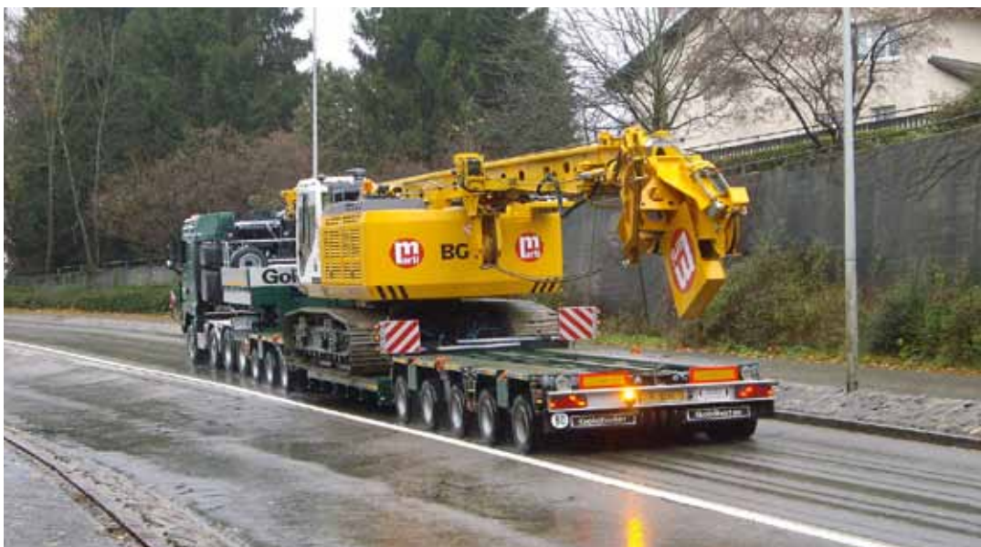
Die Christen und CIE AG hat sich für eine 8-achsige Schwerlastkombination vom Typ STZ-VH (THP/UT) mit Bagger- und Tiefbettbrücke entschieden. Das Goldhofer-Fahrzeug lässt sich flexibel und universell einsetzen.
