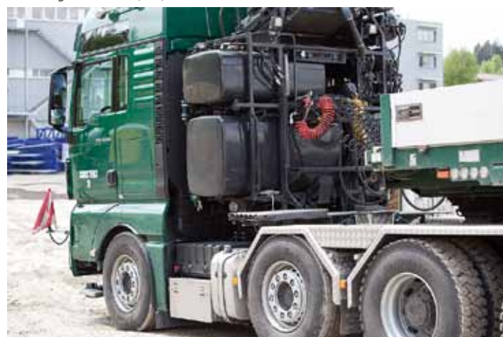
Typische Rückansicht einer Schwerlastzugmaschine. Dank hoher Motorbrems- und Retarderwirkung in Verbindung mit der erweiterten Kühleinheit ist der MAN auch bergab sicher unterwegs.
