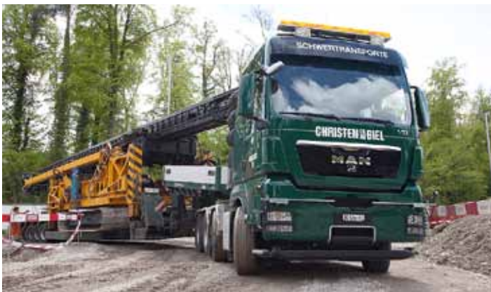
Bei dem 4-Achser ist der V8-SCR-Motor mit dem automatischen 12-Gang-Getriebe MAN TipMatic und einer Wandlerschaltkupplung kombiniert, sie ermöglicht nahezu verschleissfreies, sanftes Anfahren und zentimetergenaues Rangieren auch unter schwierigsten Bedingungen.
