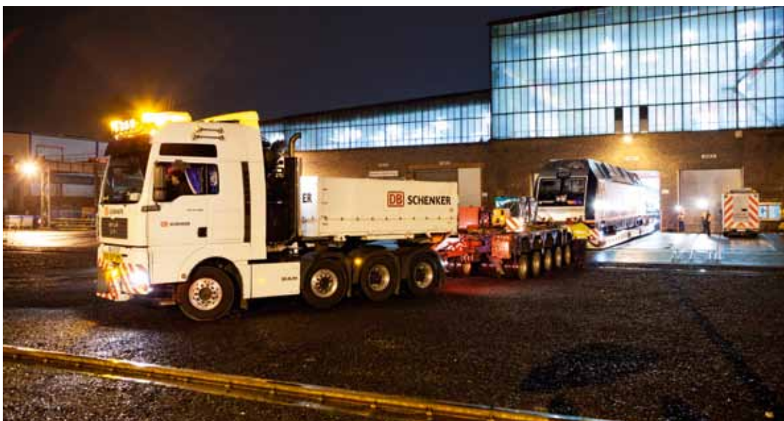
Auf einem Tieflader ging die erste Lokomotive auf den Weg nach Hamburg. Das insgesamt fast 56 m lange Gespann reiste in Polizeibegleitung von Kassel über die Autobahnen nach Norden.
