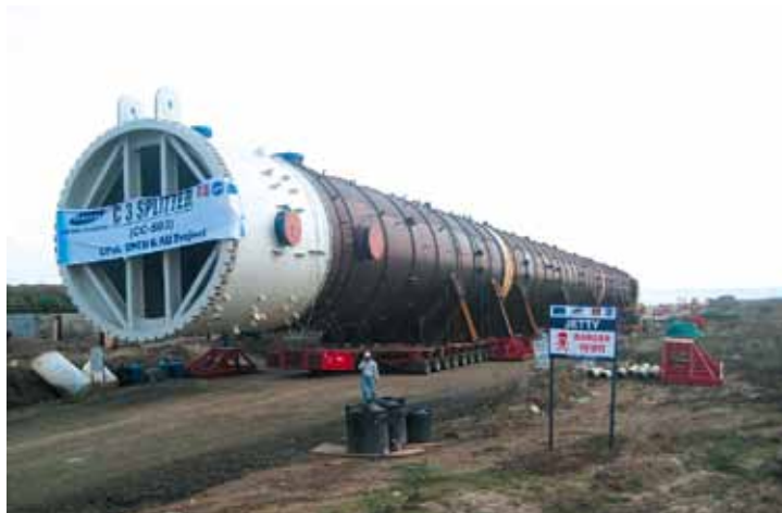
Die 1.350 t schwere Kolonne legt den Weg vom Ponton zur 1 km entfernten Ethylenanlage in Dahej auf 64 Achslinien NICOLAS „MHD SPE“ zurück. Eine weitere 1.000 t Rektifikationskolonne reist auf 48 Achslinien des gleichen Typs.
