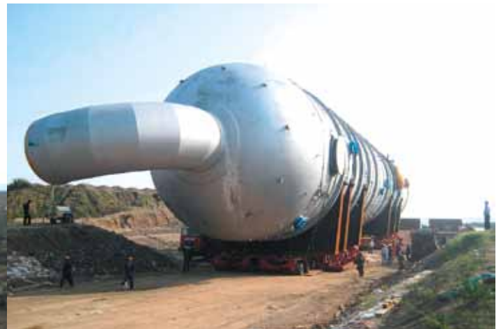
Die 1.350 t schwere Kolonne legt den Weg vom Ponton zur 1 km entfernten Ethylenanlage in Dahej auf 64 Achslinien NICOLAS „MHD SPE“ zurück. Eine weitere 1.000 t Rektifikationskolonne reist auf 48 Achslinien des gleichen Typs.
