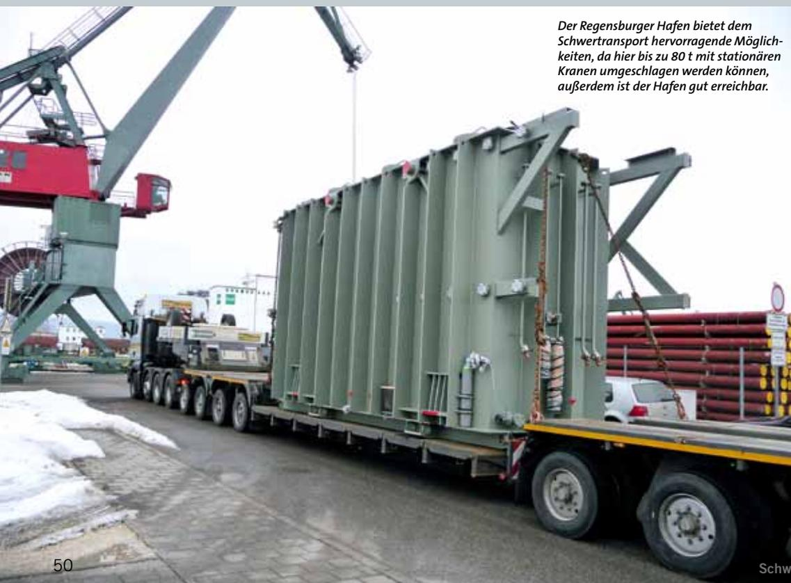
Der Regensburger Hafen bietet dem Schwertransport hervorragende Möglichkeiten, da hier bis zu 80 t mit stationären Kranen umgeschlagen werden können, außerdem ist der Hafen gut erreichbar.
