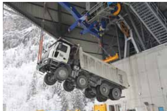
Einer der Astra HD8 Lkw, der vom Groupement Marti Implemia gekauft wurde, wird derzeit auf der Baustelle des Schweizer Kraftwerkprojektes „Linthal 2015“, eingesetzt. Die 2.000 m über dem Meeresspiegel gelegene Großbaustelle ist nur mit der Seilbahn oder dem Hubschrauber zugänglich.
