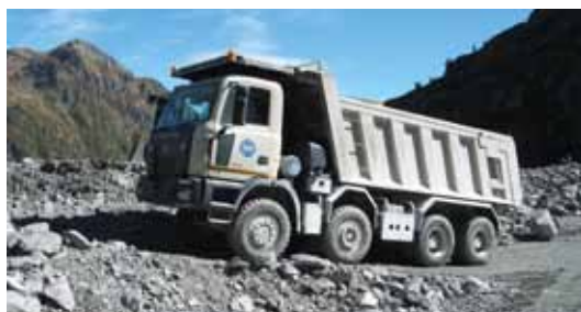
Zehn Astra HD8 wurden vom Groupement Marti Implemia für die Bauarbeiten in den schweizer Alpen angeschafft. Sie alle sind mit dem Allison 4700R Vollautomatikgetriebe mit integriertem Retarder ausgestattet.
