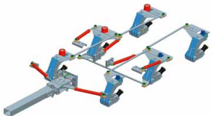
Hydraulisch gesteuerte Trailerachslenkung HF-E für Tiefeladern und Semitiefeladern mit bis zu sieben gelenkten Achsen.
