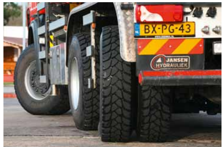
WST heißt das neue elektronisch geregelte hydraulische Lenksystem für den Einsatz an Lkw mit mehreren angetriebenen Achsen.
