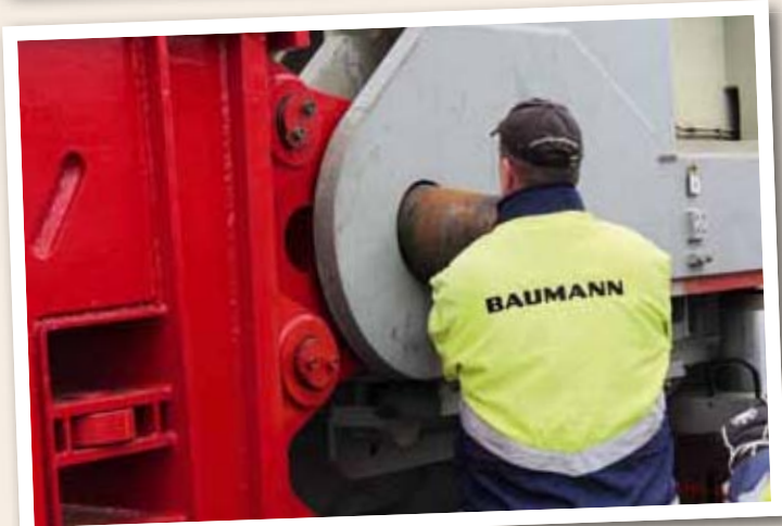
Für den Straßentransport von Hamm nach Werne wird der Trafo in der 550 t-Kesselhub-Brücke transportiert. ▲►
