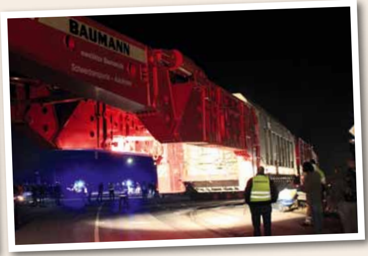
Gestreckt stehend und in einer 90°-Kurve während der Fahrt – die Hubhebel-Kesselbrücke im Einsatz. ▼►
