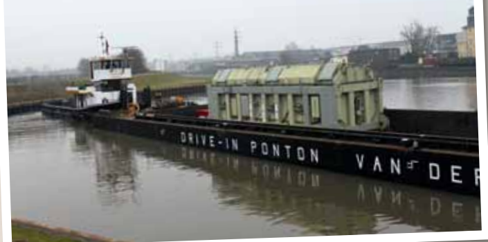
Auf einem Drive-In Ponton bewältigte der Trafo die Strecke von Rotterdam nach Hamm.
