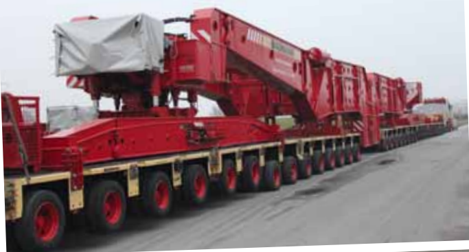
550 t Nutzlast bietet die Hubhebel-Kesselbrücke von Baumann, nachdem sie verstärkt worden ist.
