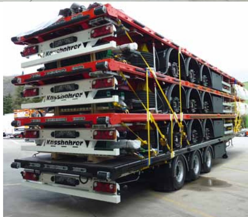
Aus vier Kässbohrer-Chassis wird ein Paket. So erreichen sie „in einem Rutsch“ das Werk in Goch, wo sie endmontiert werden. Zudem werden in Goch Servicearbeiten ausgeführt, außerdem wird das Werk als Showroom genutzt. STM-Bild
