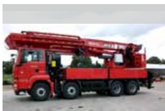
MAN-4-Achs-LKW, Typ TGS 35.440 8x4 BB, mit MKG-Ladekran HMK 991 HP Ta2-a3
