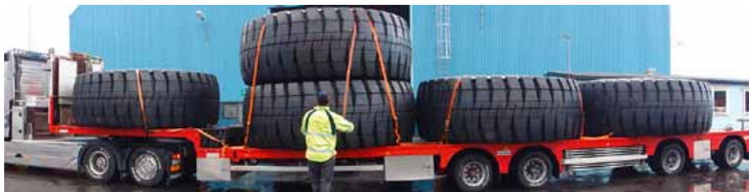
Reifen-Riesen: 4 m Durchmesser, 1,47 m Breite und 5,75 t Gewicht: Weltrekord.
