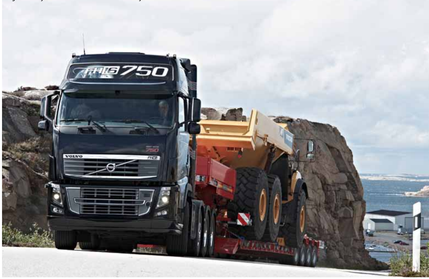
Beim FH 16 750 gehört das automatisierte Schaltgetriebe I-Shift zur Standardausstattung und wurde für das hohe Drehmoment des Motors modifiziert.
