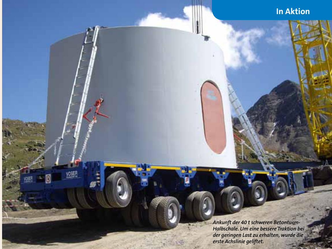
Ankunft der 40 t schweren Betonturm-Halbschale. Um eine bessere Traktion bei der geringen Last zu erhalten, wurde die erste Achslnie geliftet.
