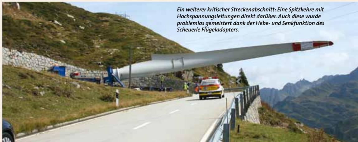
Ein weiterer kritischer Streckenabschnitt: Eine Spitzkehre mit Hochspannungsleitungen direkt darüber. Auch diese wurde problemlos gemeistert dank der Hebe- und Senkfunktion des Scheuerle Flügeladapters.
