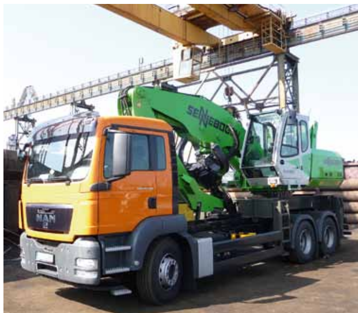
Ungewohntes Bild: Sennebogen-Maschine für den Schrottschlag als Lkw-Aufbau.
