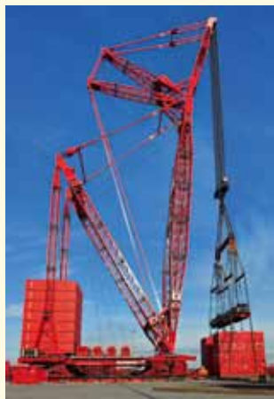
Das ist Schwerlast: PTC mit 3.520 t am Haken.
