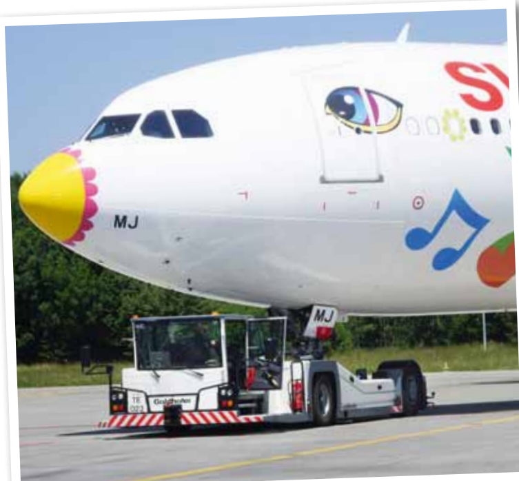
◀▶ Im Einsatz: Stangenlose Flugzeugschlepper von Goldhofer.
