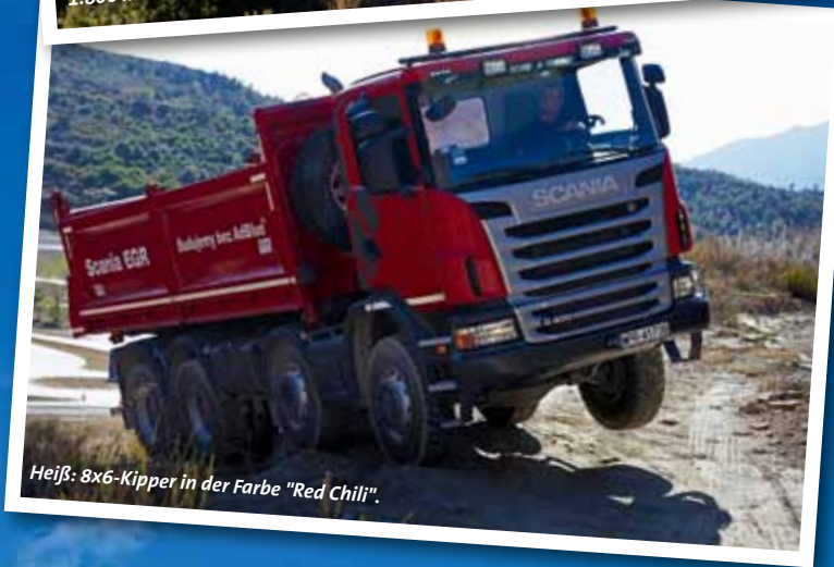
Niederländische Spezialität: 3 angetriebene Achsen mit mehr als 1.800 mm Achsabstand – ergibt 11,5 t zulässige Achslast je Achse.
