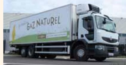
Die Reichweite des Premium Distribution Erdgas hängt vom Einsatz ab und kann zwischen 50 und 200 km variieren – je nachdem wieviel Erdgas am Lkw mitgeführt wird.
