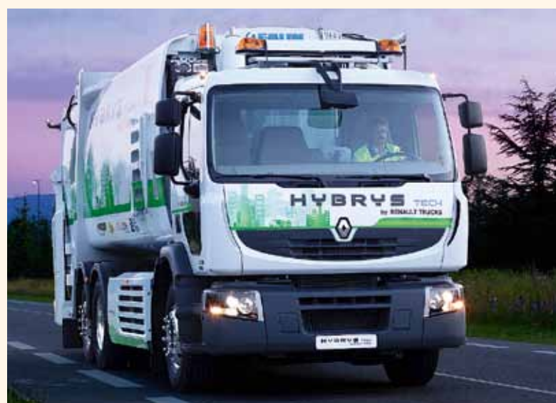
Schon 2008 testete Renault einen Hybrid-Lkw zur Müllsammlung. Das Fahrzeug wurde auf der Basis des Renault Premium Distribution mit DXi7-Dieselmotor und Optidriver+Getriebe konstruiert. Der speziell für den Hybrid-Renault entwickelte Müllaufbau stammt von FAUN.
