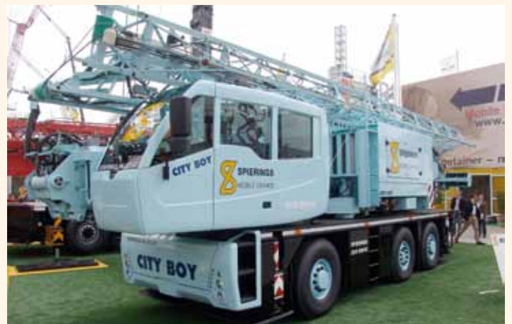
Spierings präsentierte auf der Bauma 2010 den Hybrid Kran „City Boy“ und stieß damit ins 36 tZGG-Segment vor. Der Elektromotor bietet ein maximales Drehmoment von 4.500 Nm. STM-Bild
