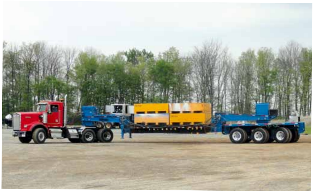
ETS-3-System für Nelson Trailers: Auf dem Foto ist der Auflieger bei seiner ersten Probefahrt zu sehen, Ballastblöcke ersetzen hier noch den Kran.
