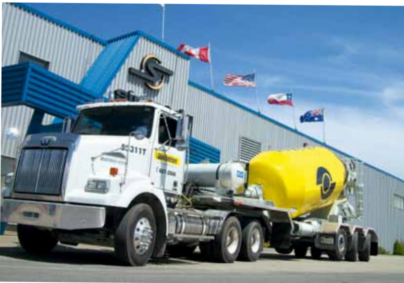
Einer der ersten Auflieger, den Simard mit ETS-Lenkung an den beiden hinteren Achsen ausstattet, wird für den Transport von Beton eingesetzt.
