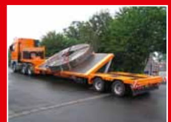
Ebert-2-Achs-Tiefbettsattelaufleger, mit integrierter Schrägladeeinrichtung und hydraulischer Zwangslenkung.
