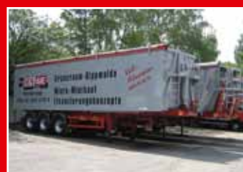
Benalu-3-Achs-Kippaufleger, bis 63 m 3 , Vollaluminium, Großraummulde.
