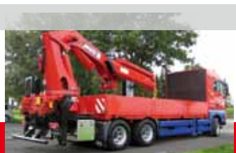
MAN-3-Achs-LKW, Typ TGX 26.440 6x4 BL, mit MKG-Ladekran HMK 591
