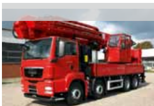
MAN-4-Achs-LKW, Typ TGS 35.440 8x4 BB, mit MKG-Ladekran HMK 991 HP Ta2-a3
