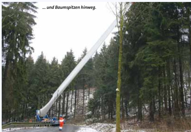
Vor der ersten Kehre wird das Rotorblatt angehoben und schwebt über Stromleitungen ...
