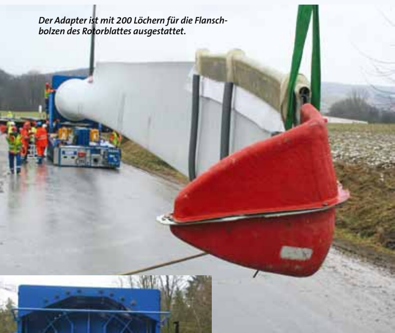
Borgholzhausen: Per Kran wird das ENERCON Rotorblatt an den Scheuerle InterCombi SP mit Windflügeladapter übergeben.
