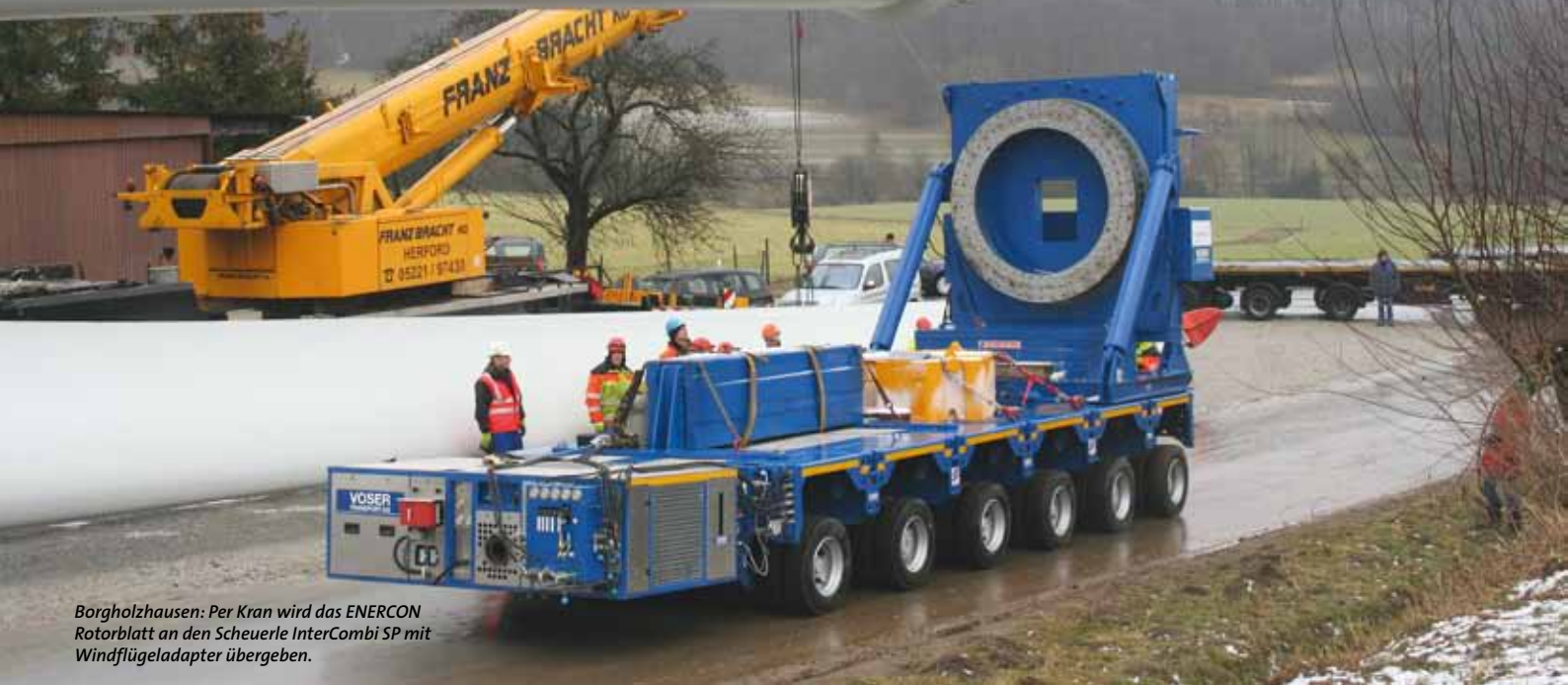
Der Adapter ist mit 200 Löchern für die Flanschbolzen des Rotorblattes ausgestattet.
