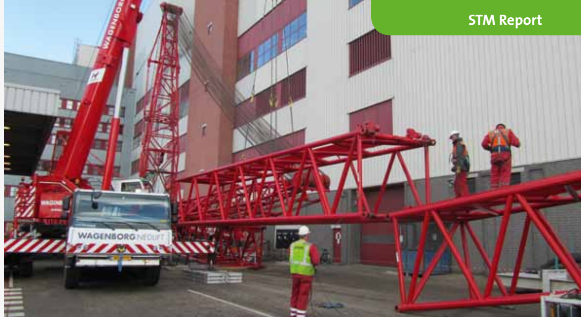
▲ Montage des Auslegersystems. ▼
