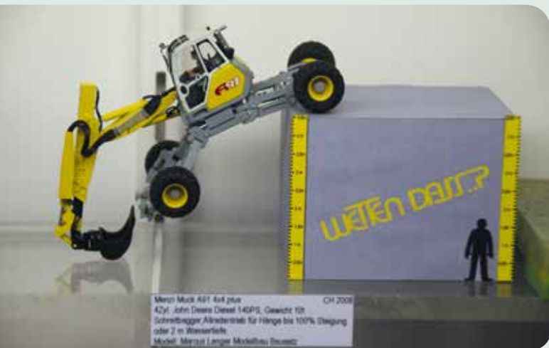
Eine „Wetten Dass..?“-Show als Vorbild: Im „Einsatz“ ist hier ein Menzi Muck A91, 4x4 plus. Der 10 t schwere Schreitbagger mit Allradantrieb ist mit einem 4-Zylinder John Deere Dieselmotor (140 PS) ausgerüstet und eignet sich für Hänge bis 100 % Steigung oder 2 m Wassertiefe. Modell: Marcus Langer Modellbau Bausatz.
