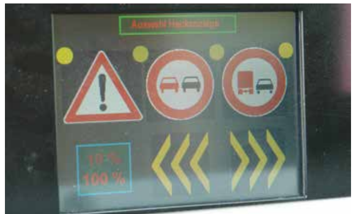
... das über einen Touch-Screen im Fahrerhaus geschaltet wird.
