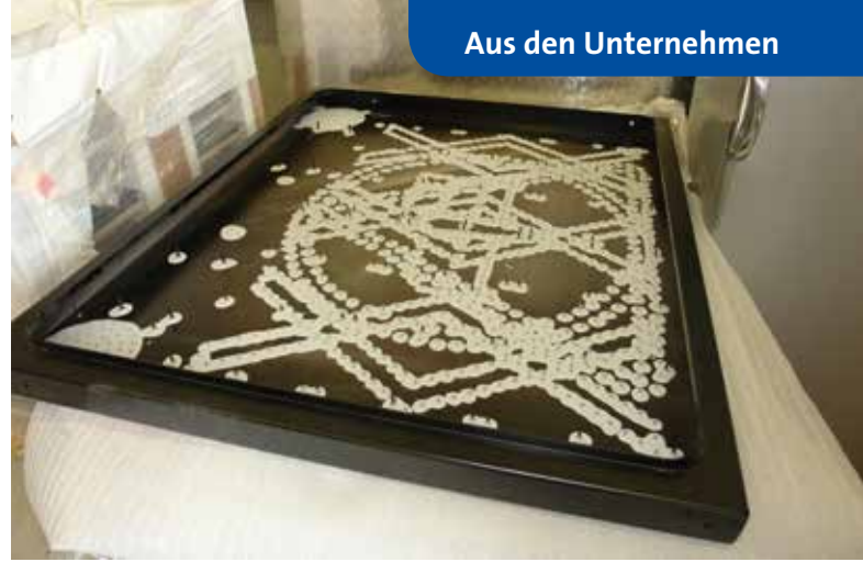
Jedes einzelne LED wird auf der Rückwand versiegelt ...
