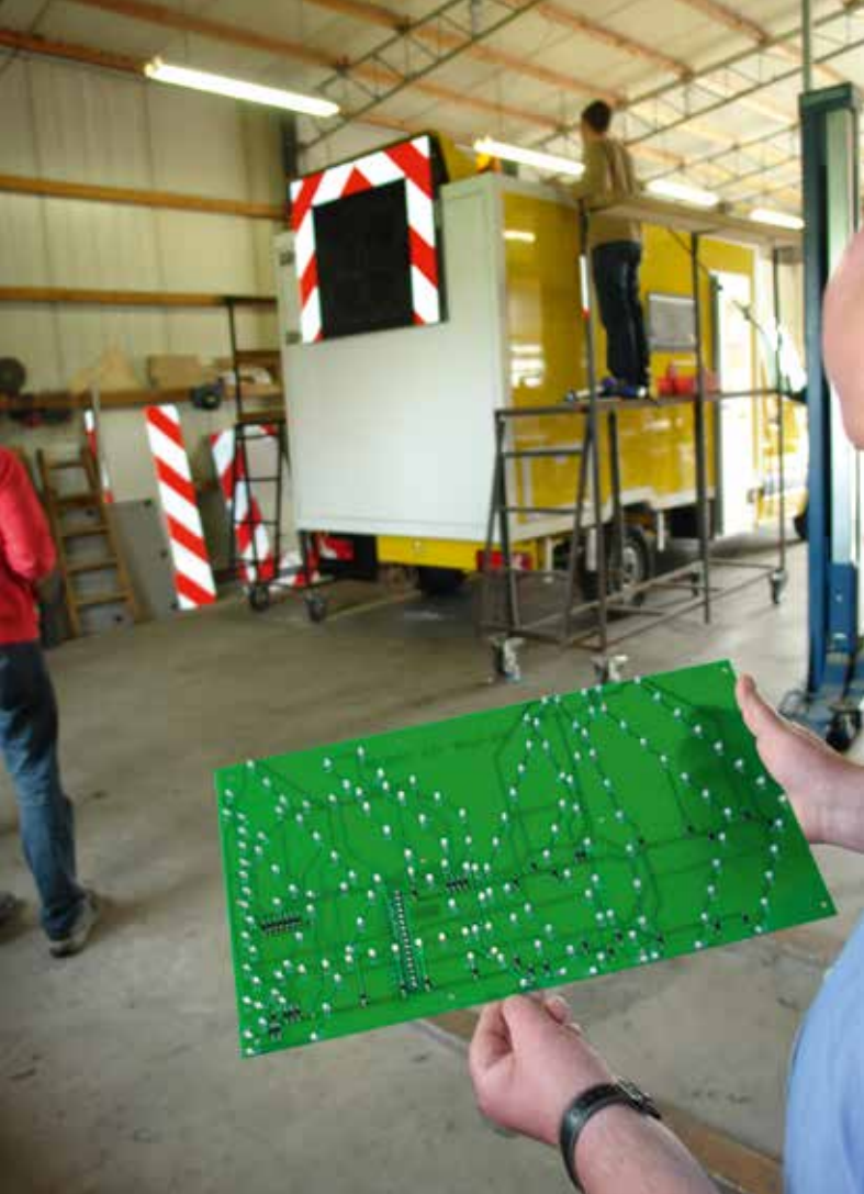
Das Herzstück der WVZ ist diese Platine.
