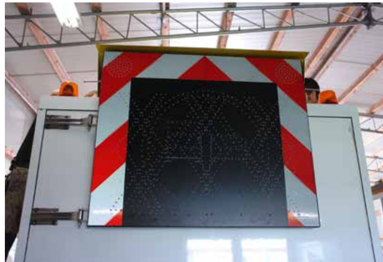
... und die WVZ mit Scharnieren an der Rückwand befestigt. So bleibt der Zugang zur Elektronik problemlos.
