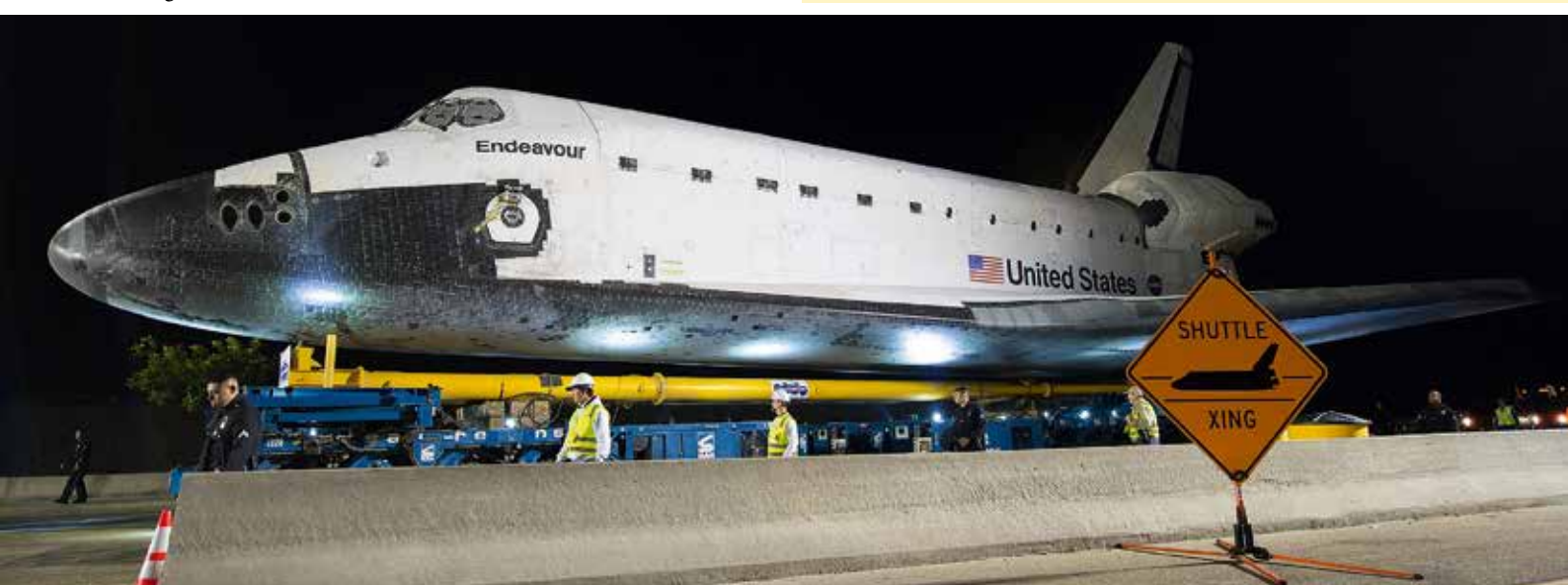
20 km durch die Straßen von Los Angeles legte das US Space Shuttle auf Modulfahrzeugen von KAMAG zurück.
