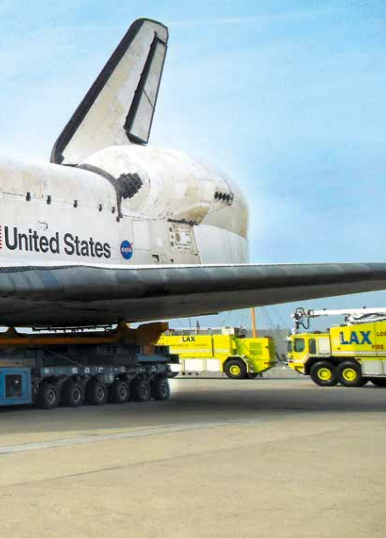
Mit 2 Kranen wurde die Endeavour auf Modulfahrzeuge von KAMAG gehoben. (Photo credit: NASA / Bill Ingalls)
