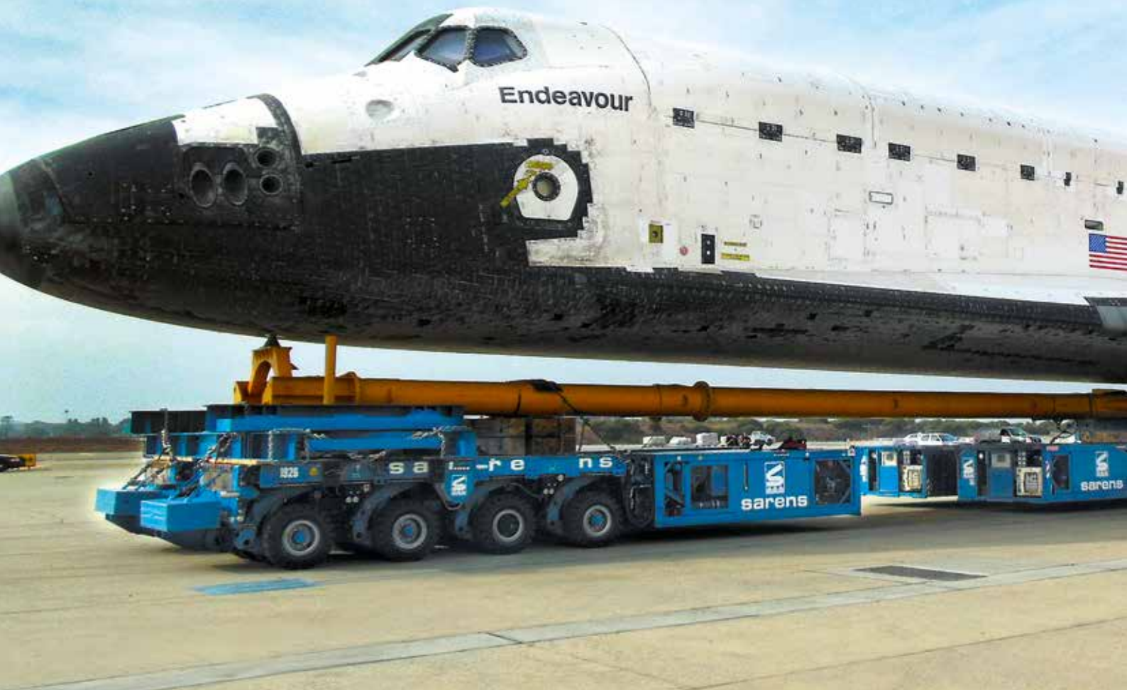
Eine Ära geht zu Ende. Die letzte Reise des letzten Space Shuttle Endeavour durch Los Angeles findet auf selbstangetriebenen Modulfahrzeugen von KAMAG statt.
