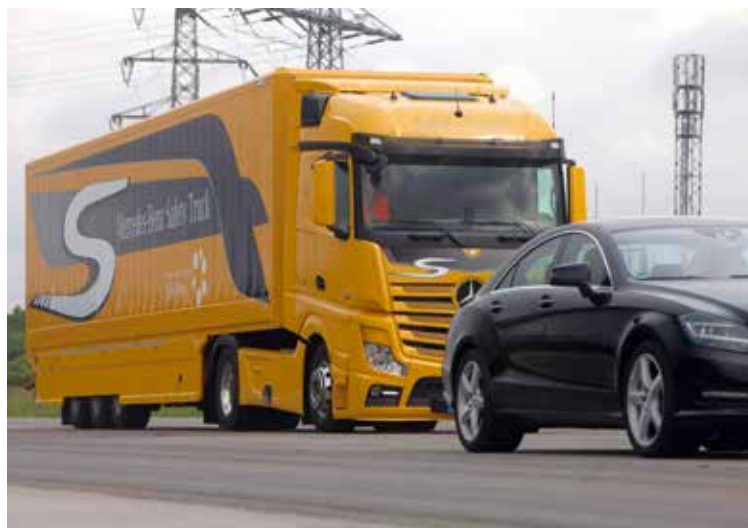
Der neue Mercedes-Benz Actros mit der dritten Generation des Notbremsystems ABA 3 leitet auf stehende Hindernisse nun auch selbstständig eine Vollbremsung ein.
