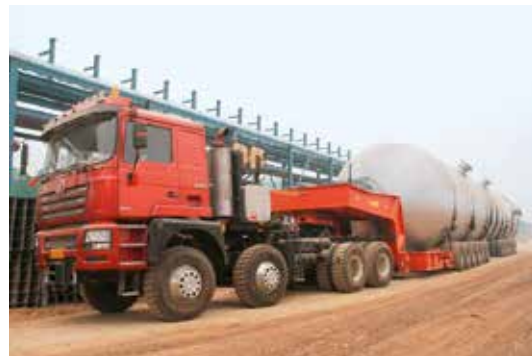
Der Antriebsstrang des neuen, überlangen Shaanxi SX5600 Sattel Schleppers besteht aus einem Allison 7-Gang Automatikgetriebe Serie 4700SP und einem Cummins Motor ISX 600 (447 kW).
