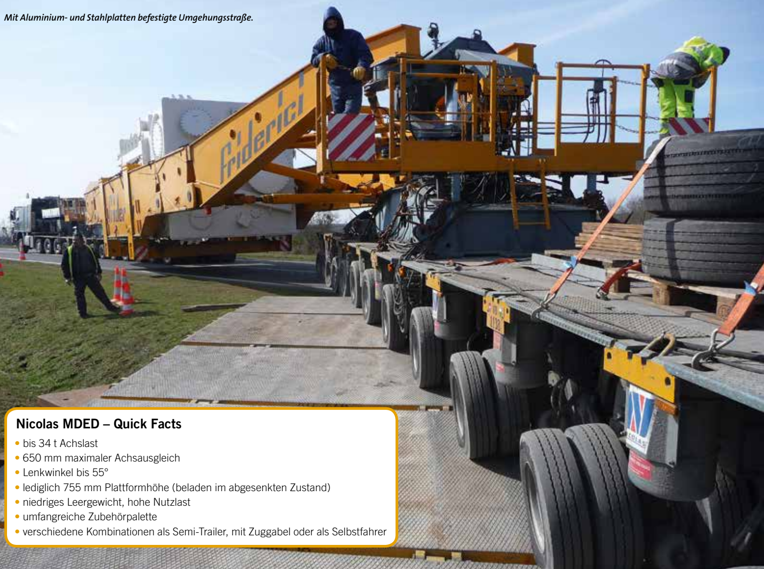
STM Umfahrung eines Kreisverkehrs kurz nach Ury. Kein Problem dank Lenkwinkeln bis 55°.
