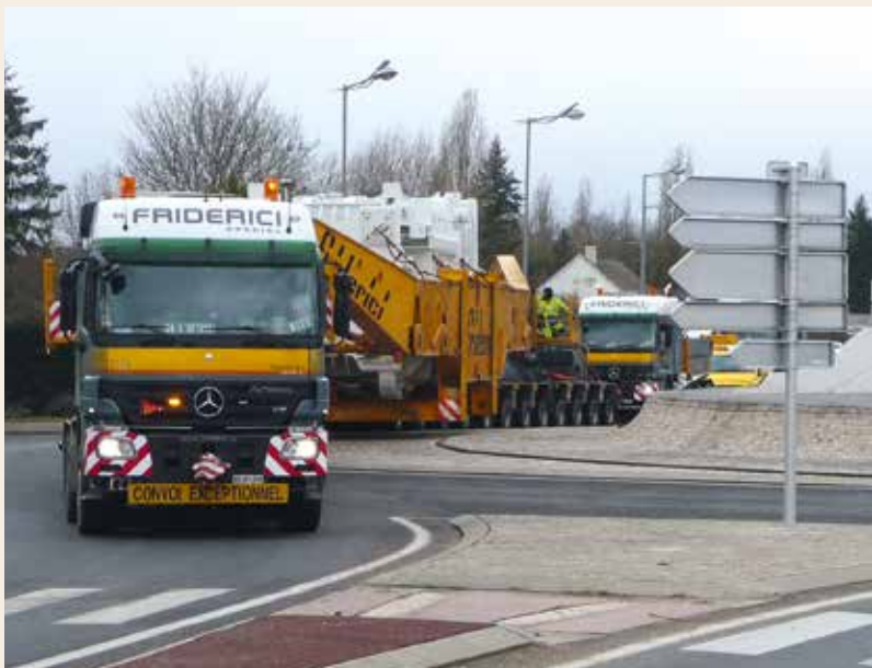
STM Umfahrung eines Kreisverkehrs kurz nach Ury. Kein Problem dank Lenkwinkeln bis 55°.
