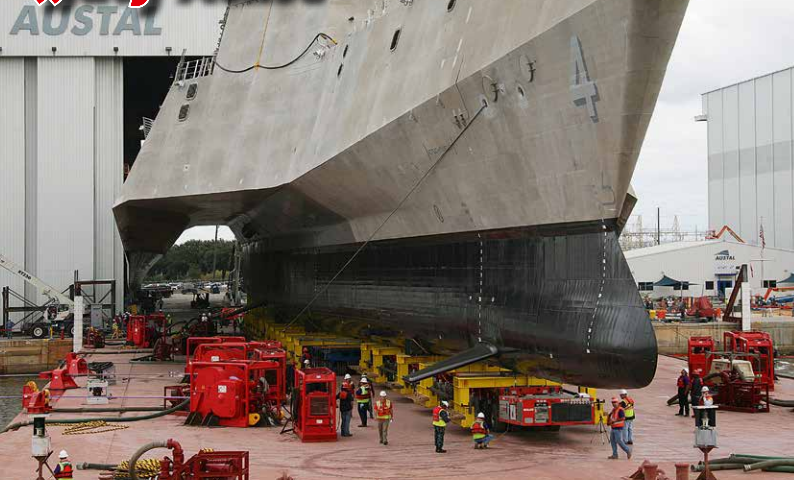
Sicherer Transport an Land: Die „Coronado“ der US Navy auf den Schwerlastmodulsystemen PST/ES-E und PST/SL-E von Goldhofer.
