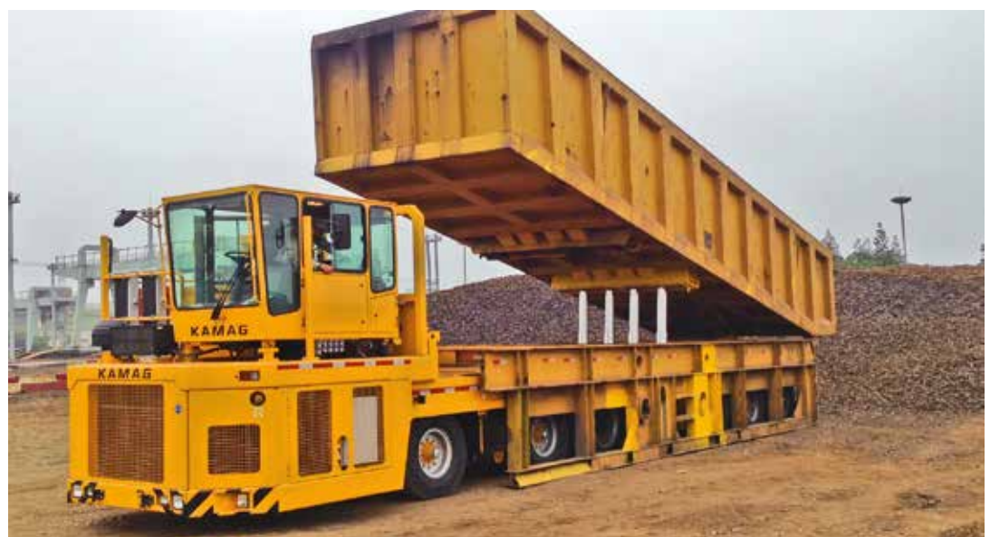
Das chinesische Unternehmen Baosteel erhielt insgesamt 13 Kamag Industriehubtransporter der Typen U2105 HM2 und 2107 HM2 (im Bild).
