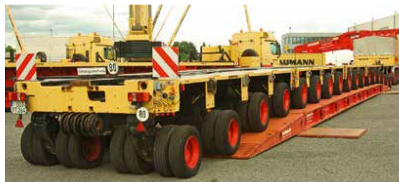
Tausendfüßler in Aktion: 17 Achslinien demonstrieren das Brückenüberfahrssystem.
