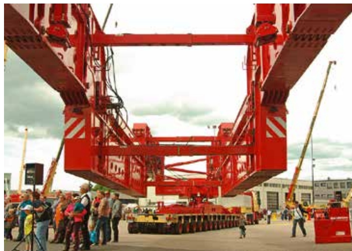
Seltener Einblick: 550 t-Kesselbrücke auf 2 x 14 Achslinien.
