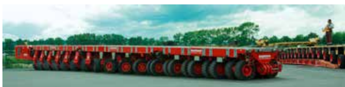
Die rund 70 t Eigengewicht sind dem als 16-Achser zusammen gekuppelten SPMT bei der Fahrdemonstration kaum anzumerken gewesen.
