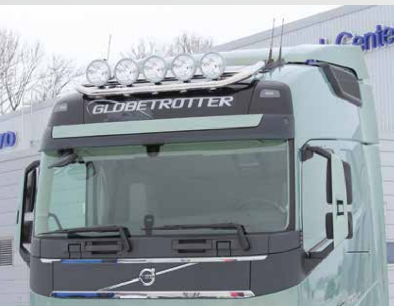
Für das Dach gibt es verschiedene Lampenbügelvarianten und Anschlusslaschen für 6 oder 4 Scheinwerfern.
