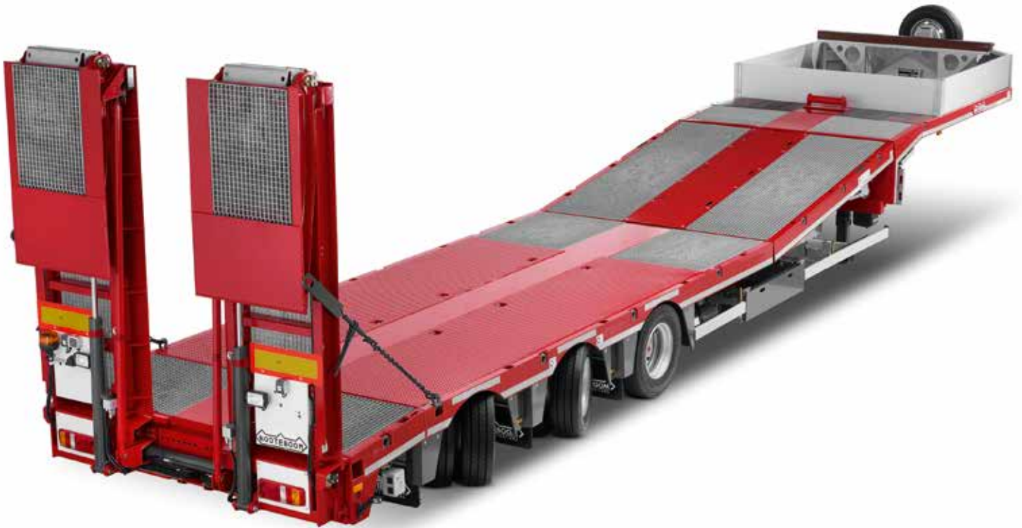
Das hydraulisch anhebbare Teilstück der Ladefläche macht es leicht, Hubarbeitsbühnen auf den Schwanenhals zu laden.
