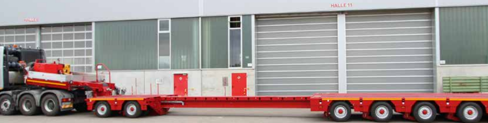
Der Superflex von Scheuerle und Nicolas im abgesenkten Zustand mit frei positioniertem 2-Achsaggregat.
