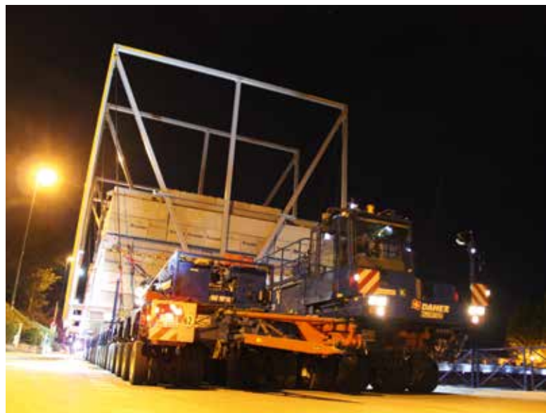
775 t Gesamtgewicht brachte der Transport auf die Waage – damit ging es über neue Brücken und zum Teil 5 bis 9 %ige Steigungen hinauf.
