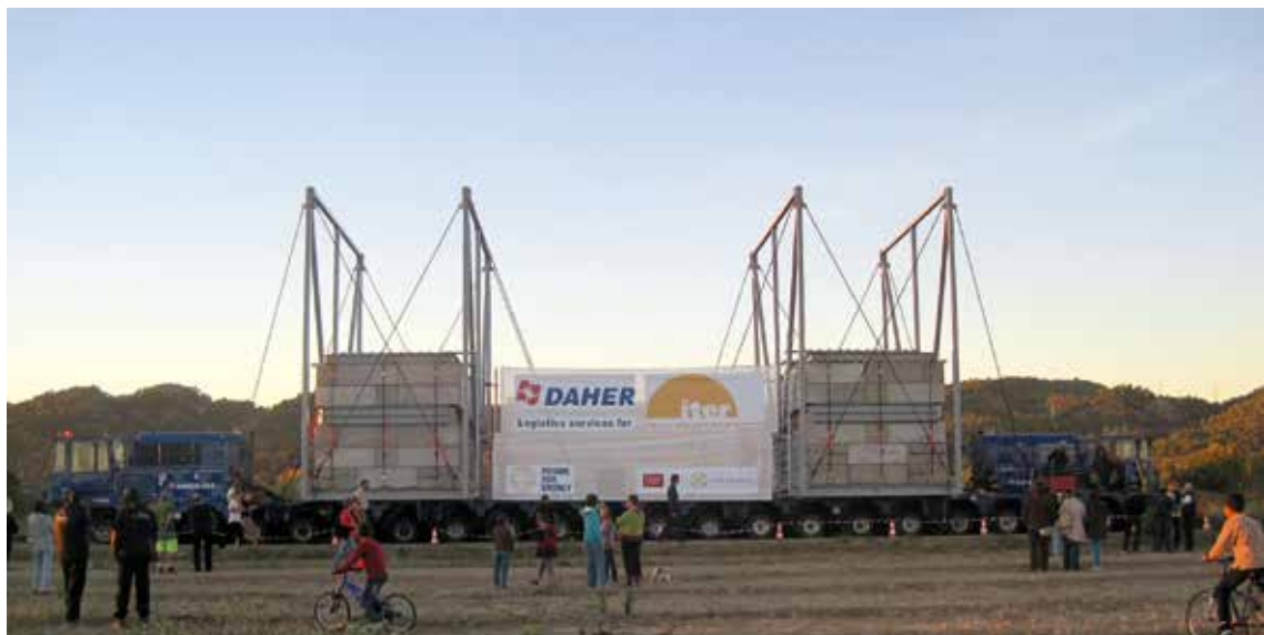
775 t Gesamtgewicht brachte der Transport auf die Waage – damit ging es über neue Brücken und zum Teil 5 bis 9 %ige Steigungen hinauf.
