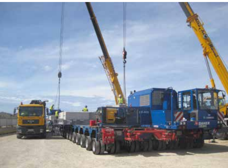
775 t Gesamtgewicht brachte der Transport auf die Waage – damit ging es über neue Brücken und zum Teil 5 bis 9 %ige Steigungen hinauf.
