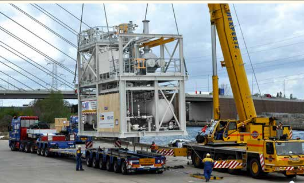
Am Hafenkai stand schon ein Grove GMK 5200 bereit, um die Mischanlage auf ein Binnenschiff zu verladen.
