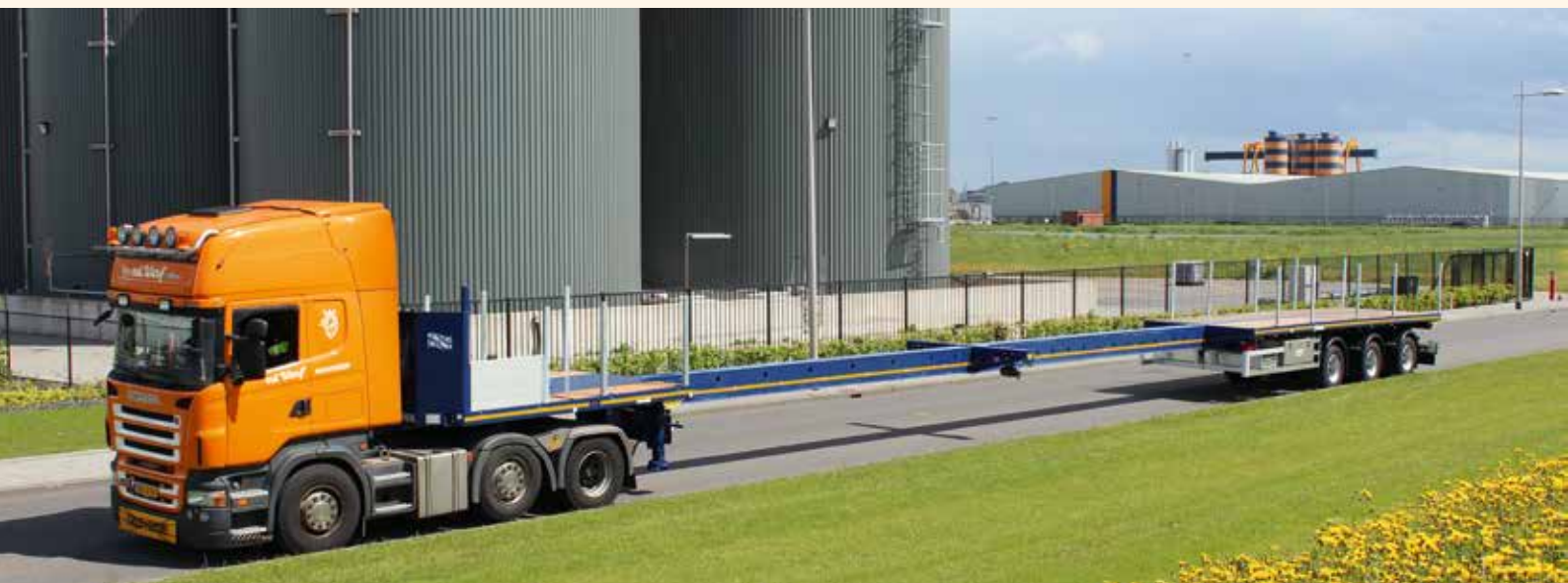
Van de Werf aus Backhuizen hat einen doppelt ausziehbaren Telesattel erhalten. Der neue Auflieger hat eine doppelt teleskopierbare Ladefläche bis 29 m Gesamtlänge.
