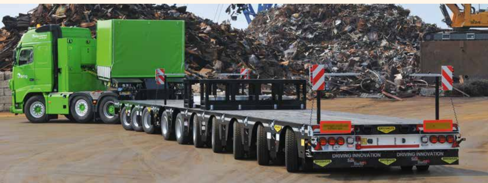
Der Schwanenhals ist mit einem Aufbau versehen, hier kann Material vor Wind und Wetter geschützt untergebracht werden.
