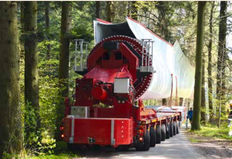
Je nach Bedarf lässt sich der Flügel in einem Neigungswinkel von bis zu 60° transportieren.
