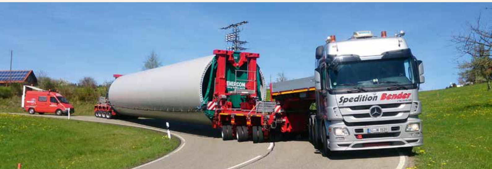
Bis zu 25 m lang und bis zu 60 t schwer waren die zu transportierenden Stahlurmsegmente.
