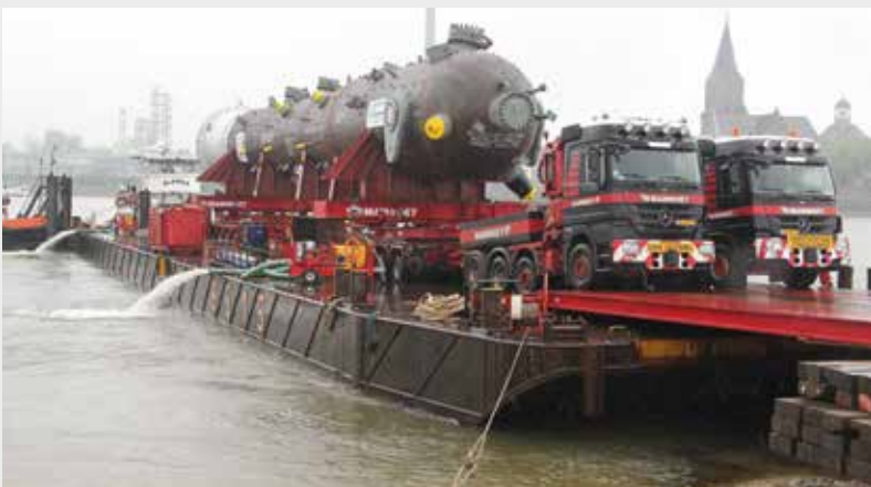
Zum Zwecke des Gewichtsausgleichs wird Ballastwasser abgelassen.
