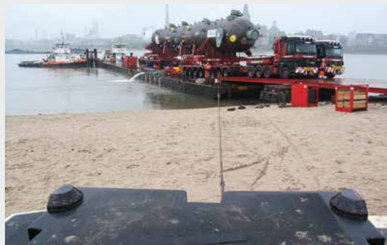
Insgesamt 160 t Kranballast sorgten am Ufer dafür, dass das Ponton nicht abtrieb.
