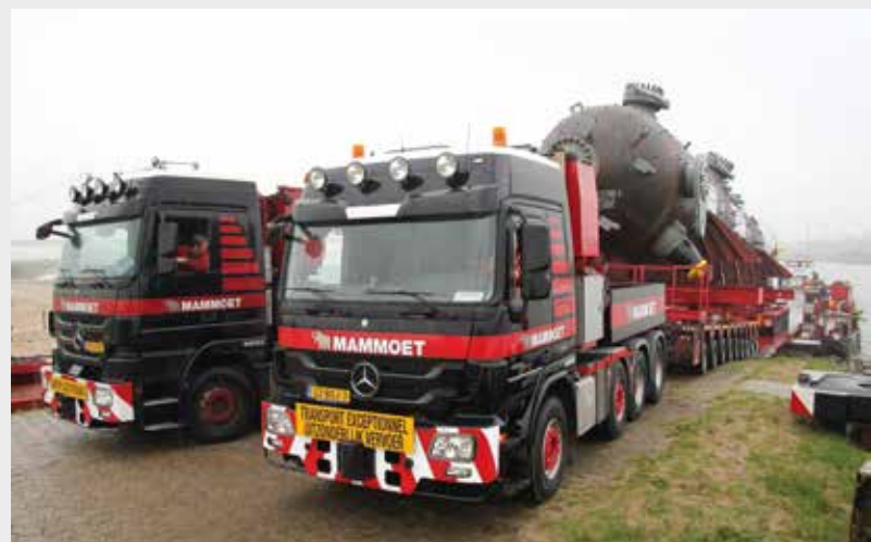
Rückwärts Auffahren auf das Ponton – und das mit parallel gekuppelten Achslinien und zwei Zugmaschinen.
