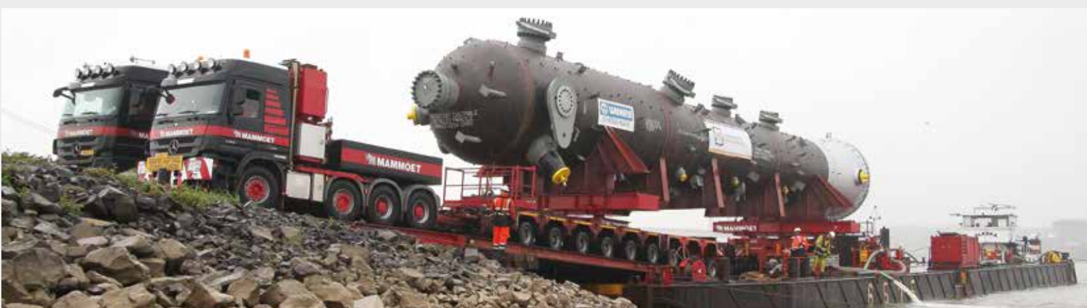
Geschafft! Die Last ist in die Endposition gebracht worden und die Schwerlastkombination kann vorsichtig vom Ponton fahren.
