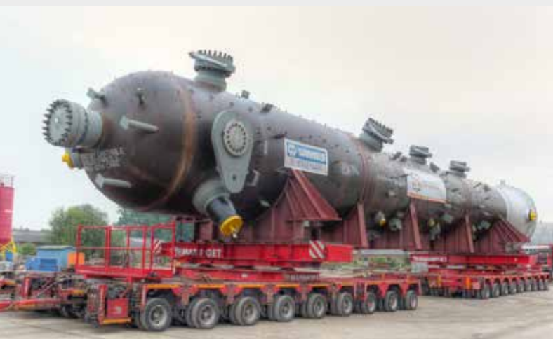
Für den Transport wurden je 2 x 9 Achslinien quergekoppelt und mit Lastaufnahmeverrichtungen für den Konverter ausgerüstet.
