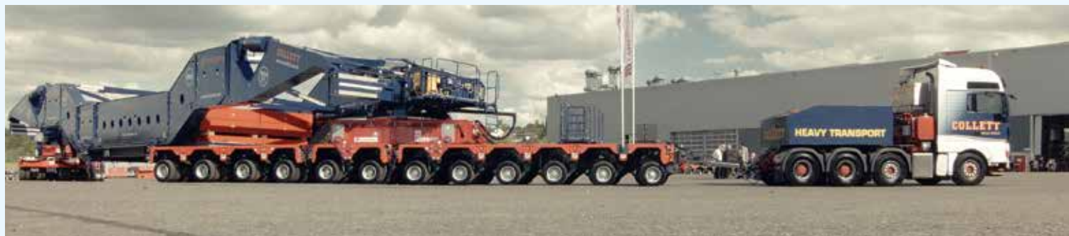
Die STB 550 ist kompatibel mit der Scheuerle Combi-Baureihe, dem Nicolas MHD sowie den selbstangetriebenen Modulfahrzeugen (SPMT) in 2-, 3 und 4-file Varianten.
