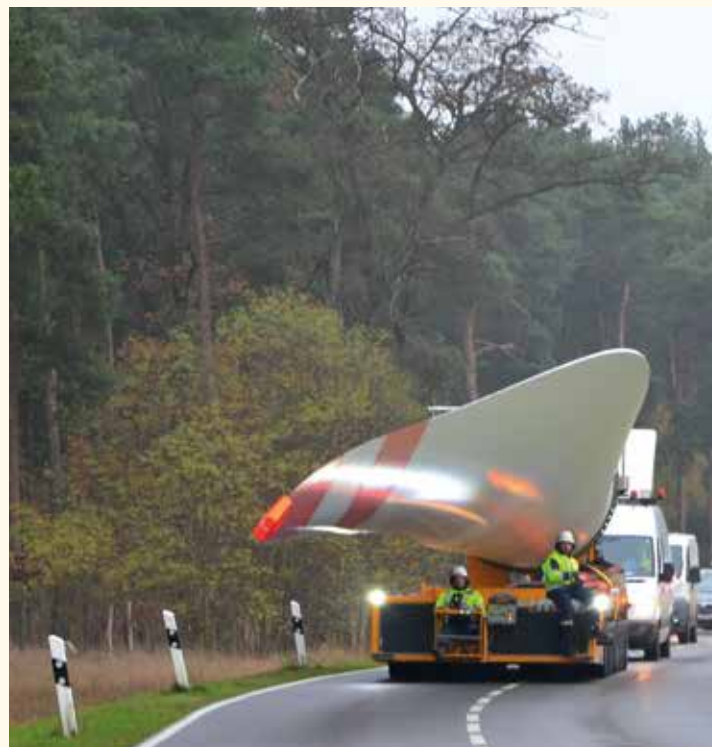
Aufgestellt, oder abgesenkt: dank der Flügel-Transportvorrichtung lässt sich die Position des Ladeguts optimal an den Streckenverlauf anpassen.
