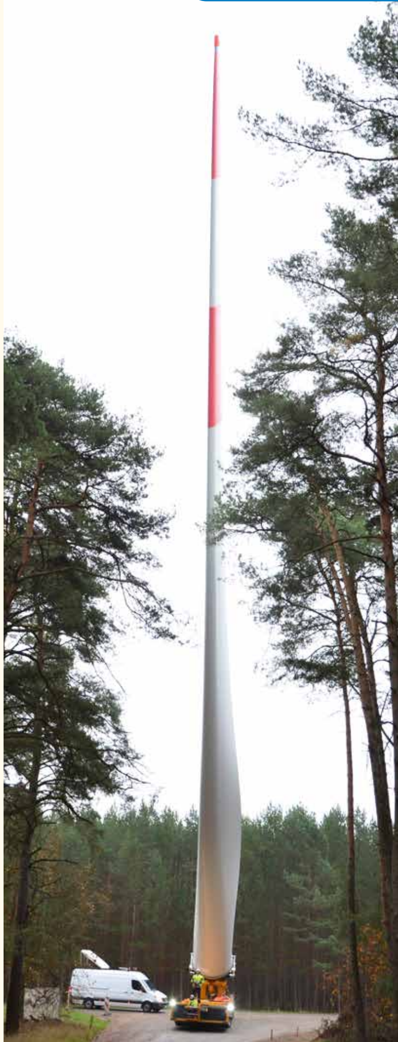
An dieser Stelle und an einer 90°-Kurve im Ortsgebiet von Vieritz wurde der Windflügel aufgerichtet transportiert.
