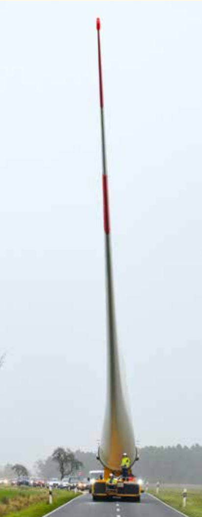
Aufgestellt, oder abgesenkt: dank der Flügel-Transportvorrichtung lässt sich die Position des Ladeguts optimal an den Streckenverlauf anpassen.
