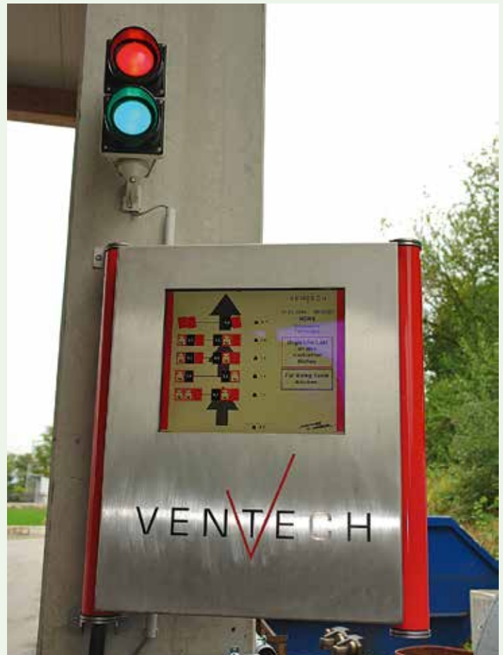
Anzeiger: Auf dem Display sind kontrollbedürftige Reifen sofort erkennbar.
