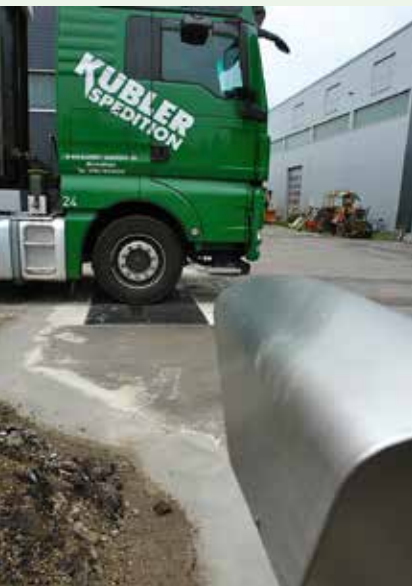
Erkenner: Die Kamera identifiziert über die Ziffern an Zugmaschine und Auflieger/Anhänger die jeweilige Einheit.
