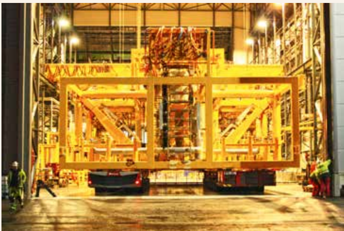
Bei der Ausfahrt aus der Montagehalle. Hier werden die Dimensionen des Pumpenmoduls sichtbar. Sicher auf Kombination aus Nicolas MHD SPE G1 und G2 verstaут, wird es Richtung Kaimauer bewegt.
