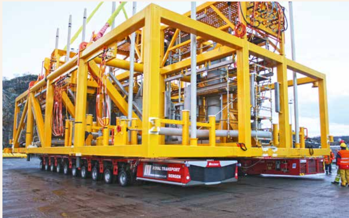
Diese 420 t schwere Pumpstation ist für den Einsatz am Meeresgrund bestimmt. Sie zu transportieren stellte für die Kombination aus Nicolas MHD SPE G1 und G2 keine allzugroße Herausforderung dar.
