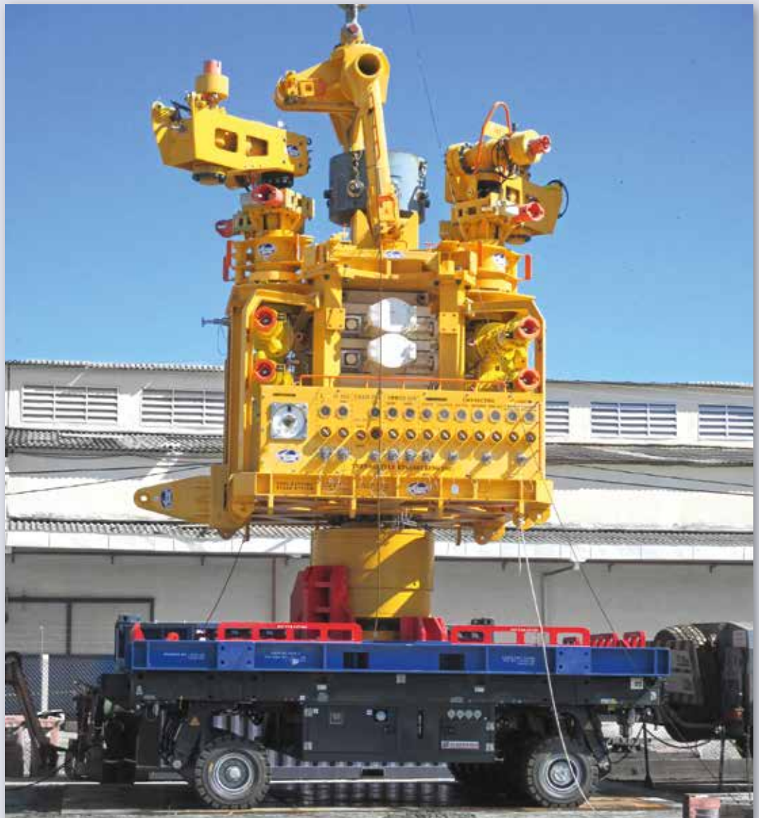
Die hydraulischen Pendelachsen bieten beim Transport des Verschlusschachts Stabilität.
