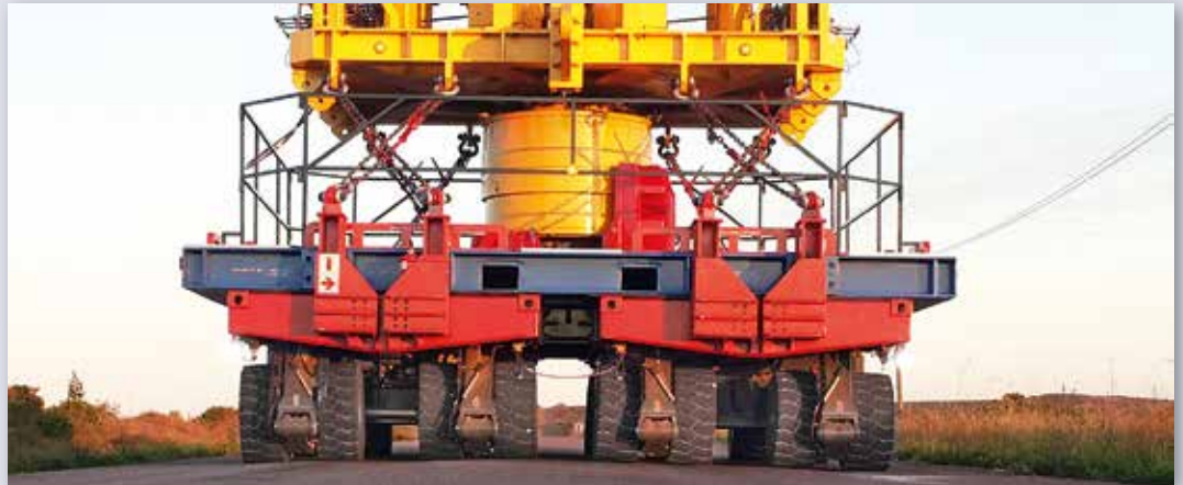
Der 120 t schwere Verschlusschacht lagert permanent auf dem SPMT Light, um bei Bedarf abfahrbereit zu sein.
